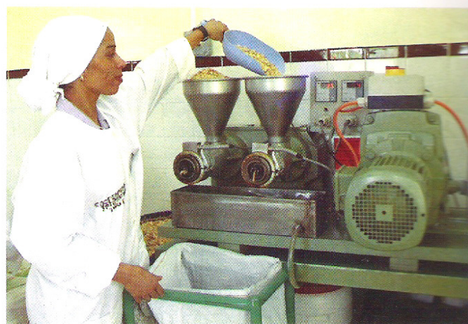
Méthode mécanisée de production de l'huile d'argan
